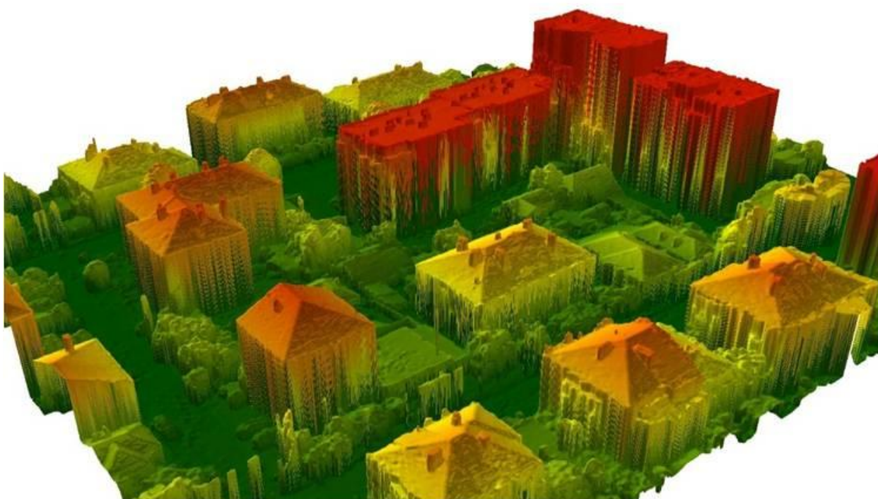
Фигура II.3-4. Цифров модел на повърхността (DSM)
