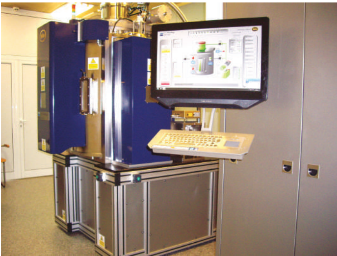
Високотехнологично оборудване за нанасяне на екологични многослойни наноструктурирани покрития чрез разбалансирано магнетронно разпръскване
