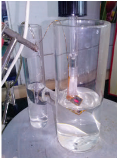
Изглед на клетка с диамантен електрод по време на облъчване
