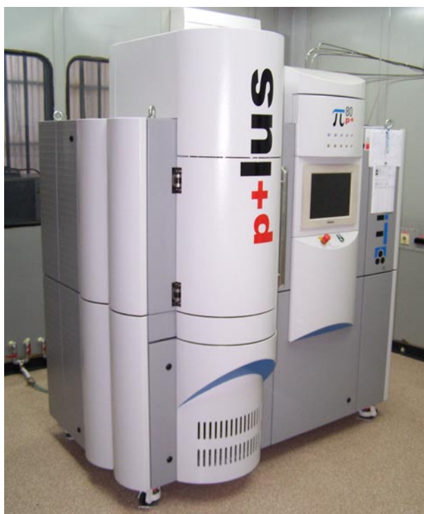
PVD оборудване „PLATIT \pi 80^{++} “ за нанасяне на твърди и свръхтвърди наноструктурирани и нанокomпозитни покрития Централна лаборатория по приложна физика – Пловдив
