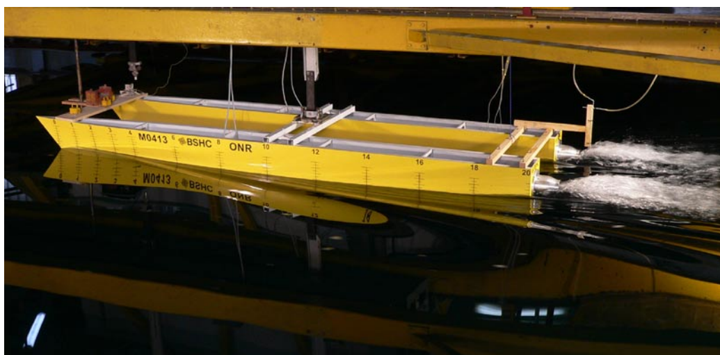
Изследване ходовите характеристики на високоскоростен катамаран с водометни двигатели за Департамента за военноморски изследвания – САЩ
