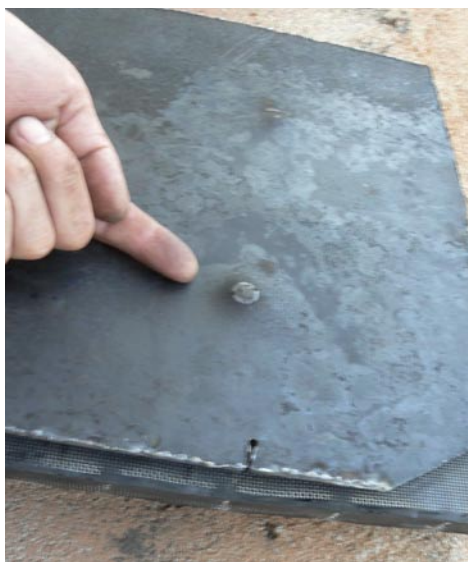
Композитен материал от боркарбидна керамика и бронейбона стомана след изстрел от снайпер
