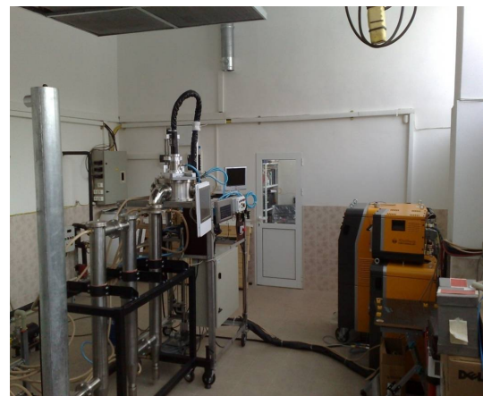
Електролъгова плазмохимична инсталация за получаване на наноразмерни материали
