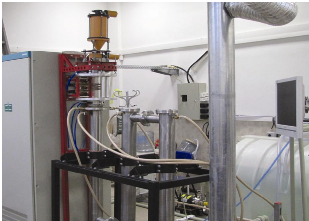
Висококачествена плазмохимична инсталация за получаване на наноразмерни материали
