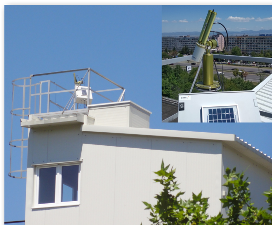
Площадката на покрива на ИЕ – БАН и инсталираният на нея слънчев фотометър Cimel CE318-TS9 (вляво); Дневни вариации на аерозолната оптична дебелина, получени с фотометъра и представени на сайта на световната мрежа AERONET (вдясно)
