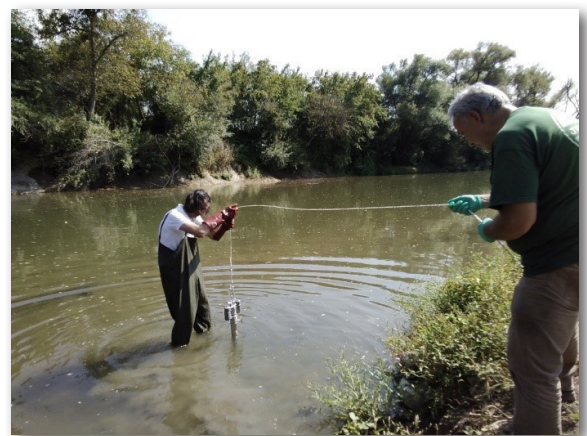
Пробовземане на дънни седименти в станция „Роман“ с новозокупения ядков пробовземач
