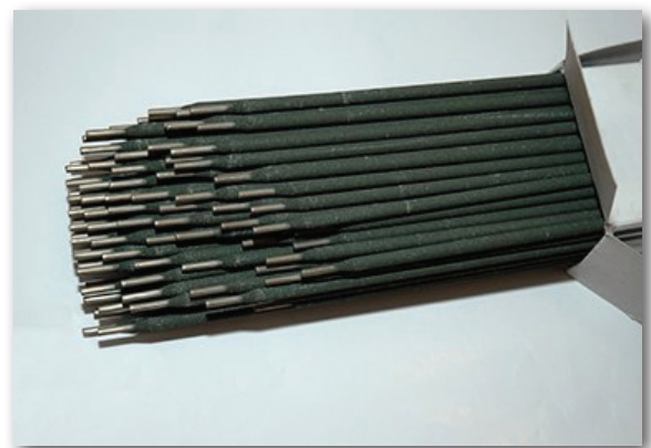
Електроди E 24 7 Mn Mo N за ръчно електродъгово заваряване на аустенитни безникелови неръждаващи стомани с високо съдържание на азот
