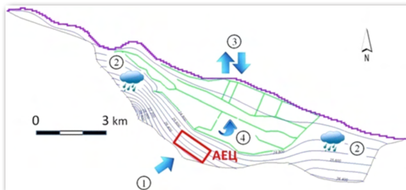
Регионален модел на Козлодуйската низина: 1 – страничен приток на подземни води; 2 – инфилтрационно подхранване; 3 – дрениране от р. Дунав; 4 – отток в дренажна система
