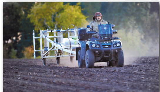
Геомагнитното изследване, проведено с моторизирана система, която е оборудвана с 8 Fluxgate сензора
